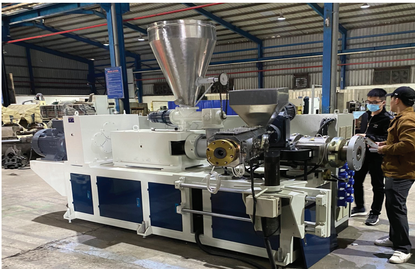
Hình 4. Máy ép đùn hai trục vít với bộ phận cài tiến phủ trực tiếp lớp bề mặt lên sản phẩm trong quá trình ép đùn - sản phẩm do Công ty TNHH Công nghiệp Quang Nam nghiên cứu chế tạo.
